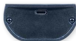
USB připojení na dolní straně přístroje
